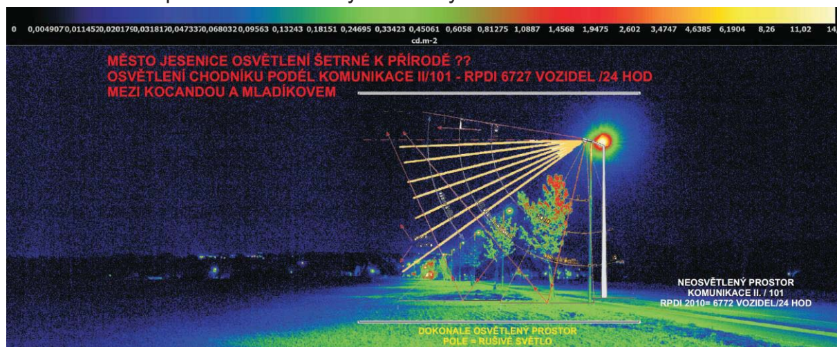
Obr.4 Dokonale osvětlený prostor pásu pole v šířce vozovky [5]
