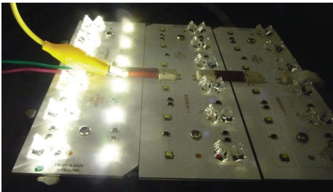
Obr.3 Příklad modulárního uspořádání LED panelů ve svítidle
